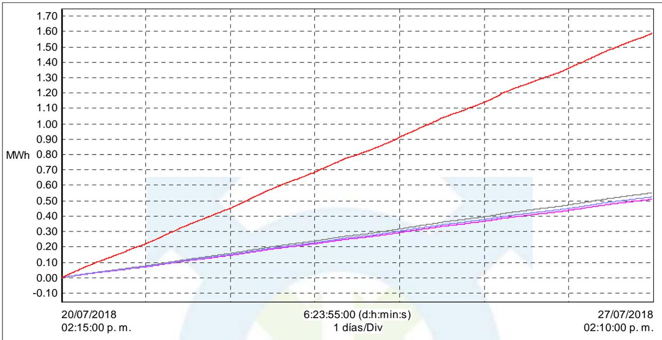
Figura 15. Consumo de energía expresada en MW·h en la sección B, en un periodo de 7 días.
