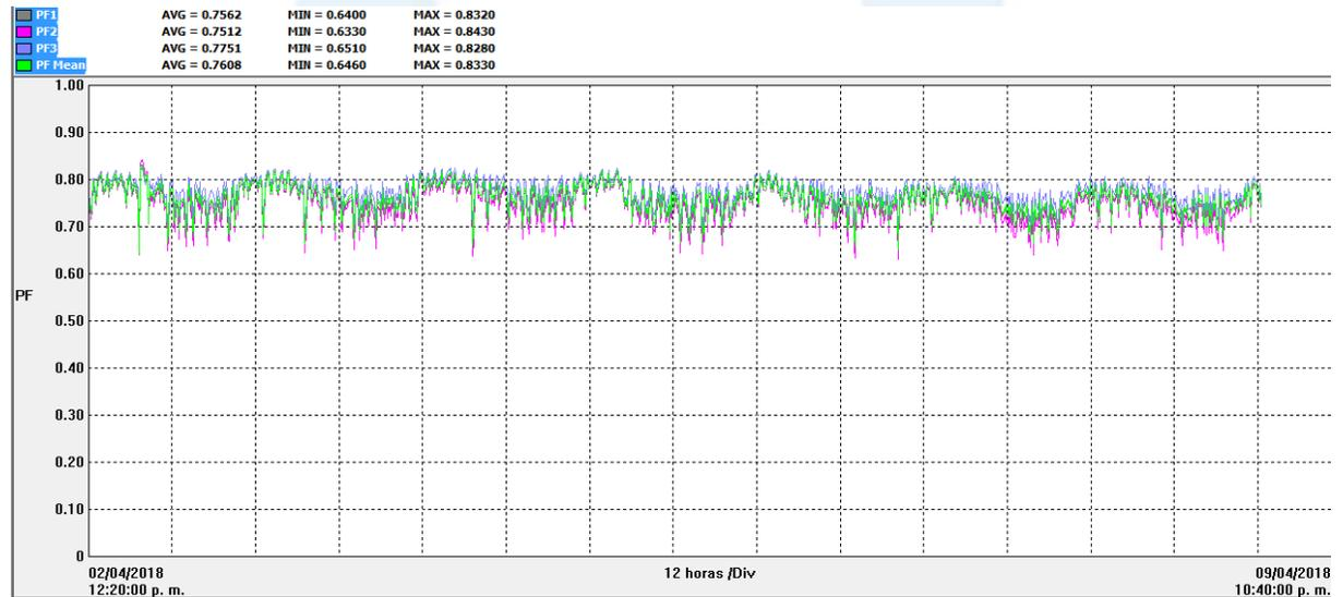
Figura 10. Tendencia de medición del factor de potencia en la sección B.
