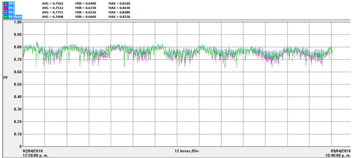
Figura 9. Tendencia de medición del Factor de potencia en la sección A.
